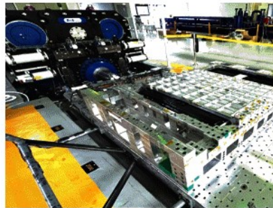
울산 TP와 세인이엔지가 자동차 충돌시 안전부품(에어백, 안전벨트, 배터리 및 시트 등)의 안전성을 검증하기 위해 실험 중인 '충돌시험 모사장비'. 사진제공=울산 TP
