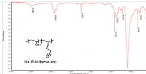
[ 겔 고분자 전해질 형성용 조성물에 포함되는 제1 중합체에 대한 IR 분석 결과 ]
