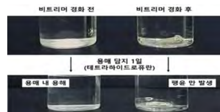
[비트리머 고분자의 용매에 대한 내용제성 비교 평가를 통한 가교결합 형성 확인]
