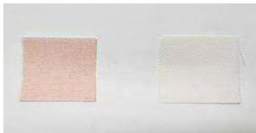
[ 처리 용액을 이용한 처리 전 후의 에어백 직물의 외관 사진 ]
