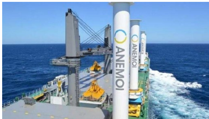
[ 선박에 설치된 로터세일 수직 실린더의 모습 ]
